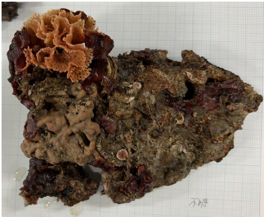
図 C3区 海底表面採集 不明鉄製品 鉄分Feは蛍光X線で確認 された。
