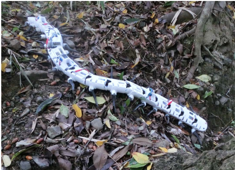
開発したムカデ型ロボット「i-CentiPot」
